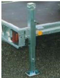
Teleskopstütze (mit Sperrbolzen arretierbar, Feineinstellung über Handkurbel)
