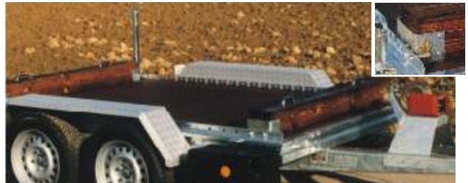
Ladungssicherung: 2 Sperrbalken in Arretierschienen über die gesamte Anhängerlänge verstellbar, Seilwinde auf Windenbock.
