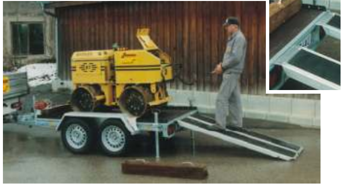
MT 2702 mit Zubehör: Seilwinde 900 kg, stabiler Windenbock, Ladungssicherung z. B. für Walzentransporte, Aluminium-Auffahrampen mit Antirutsch-Gummibelag inkl. Halterungen und Rohrstützen.
