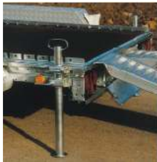
Rohrstützen mit doppelter Klemmhalterung.
