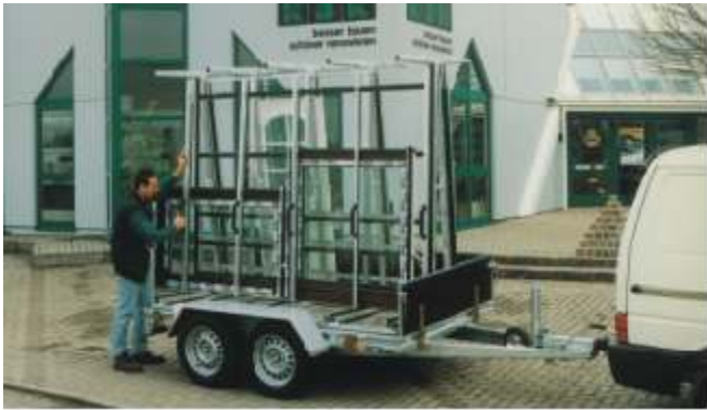
MT 2702 mit Zubehör: abnehmbare Multiplex-Bordwände, Verschleißbelag aus Alu-Riffelblech, Aluminium-Transportgestell für Bauelemente (2500x1500x2000 mm) mit Lochschienen und Alu-Spannlatten.
