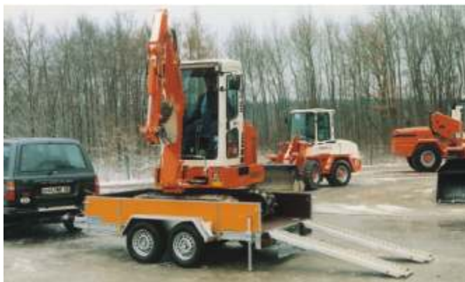
MT 3502 mit Zubehör: abnehmbare Multiplex-Bordwände , auf Wunsch außen in RAL-Ton lackiert und Alu-Auffahrrampen inkl. Rohrstützen. Der Bagger läßt sich bei eingesteckten Bordwänden drehen.
