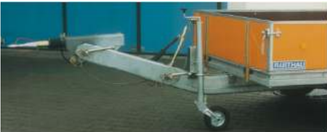
MT 3502 mit höhenverstellbarer Auflaufbremse und LKW-DIN-Zugöse, verstellbar von 400 bis 1100 mm Anhänghöhe.
