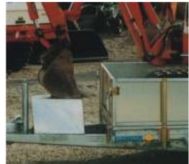
Baggerlöffelablage , auf V-Deichsel montiert. Stützrad platzsparend in den Zugholmen befestigt.
