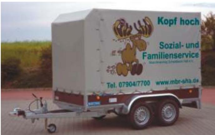
**Dachgestell** 1600 mm oder 2000 mm Ladehöhe, windschnittig vorne abgeschrägt mit niedrigem  $c_w$ -Wert. Dachgestelle serienmäßig mit Vierkantrohren verschraubt, deshalb leicht zerlegbar. Alle Teile gegeneinander austauschbar.
