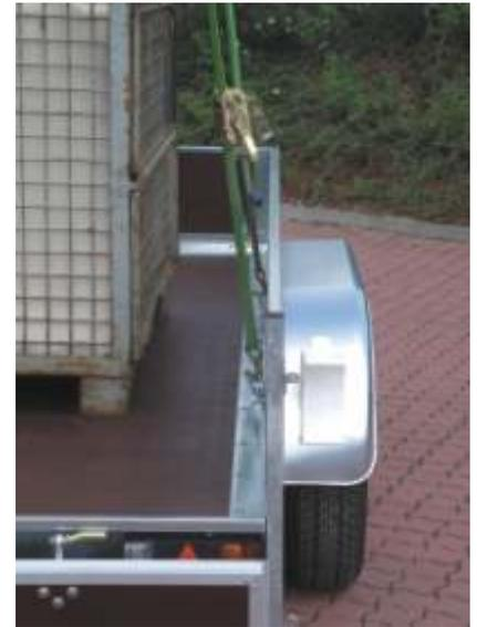
**TOPZURR24** das innovative Rahmensicherungssystem von BARTH AU. Keine Belastung der Seitenwände - direkte Einleitung der Zurrkräfte in den Rahmen. Die Nockenfittings sind versenkt montiert - volle Nutzung der gesamten Ladefläche.
