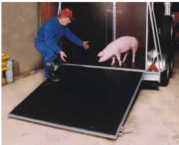
Verschleißbelag aus 8 mm Gummimatte im Laderaum mit Kantenversiegelung sowie auf der Heckklappe ohne Latten.
