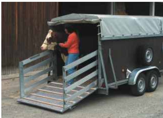
Laufgatter aus Aluminium auf Heckklappe schwenkbar. Beide Laufgatter werden während des Transports hinten quer aufgestellt. Verschleiß- und Schutzbelag aus Alu-Riffelblech im Laderaum mit seitlicher Kantung und auf Heckklappe.
