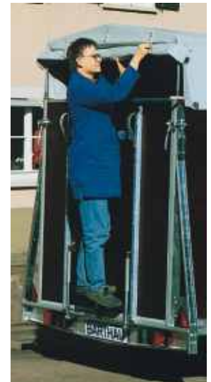
Serienmäßige Trittstufe aus Alu-Riffelblech - für einfacheres Hochrollen der Plane.
