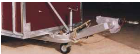
Höhenverstellbare Auflaufbremse , mit DIN-Zugöse.
