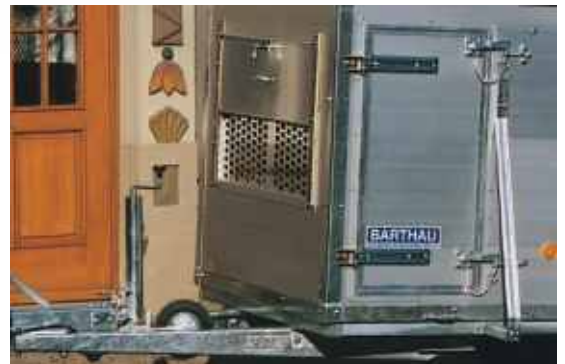
Grundrahmen aus Doppel-Z-Profilen, feuerverzinkt . Stabile V-Zugholme mit großer freier Deichsellänge für leichtes Rangieren. Schweres, automatisch umklappbares Stützrad in der V-Deichsel montiert. Große, zugfreie Schluftpüre mit Alu-Überschlagprofil. Lüftungsschieber auf Wunsch.
