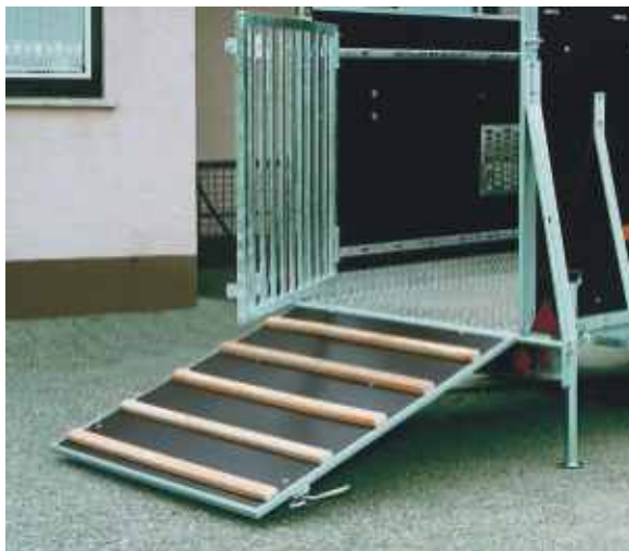
Trengitter , feuerverzinkt, quer montiert, mit Verstellschienen. Verschleißbelag aus Alu-Riffelblech im Laderaum mit seitlicher Kantung. Rohrstützen mit Klemmhalterung.
