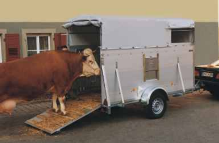
VR 1801 in Aluminium-Ausführung mit 1250 mm hohen Seitenwänden. Zubehör: Regelbarer Lüftungsschieber (450 x 300 mm) in Seitenwand, Dachgestell und Plane 600 mm hoch.
