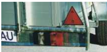
Heckklappe mit komplett geschützter Scharnierwelle - kein Verkleben von Stroh möglich. Geschützt montierte Beleuchtungseinheit mit Rückfahrcheinwerfer.
